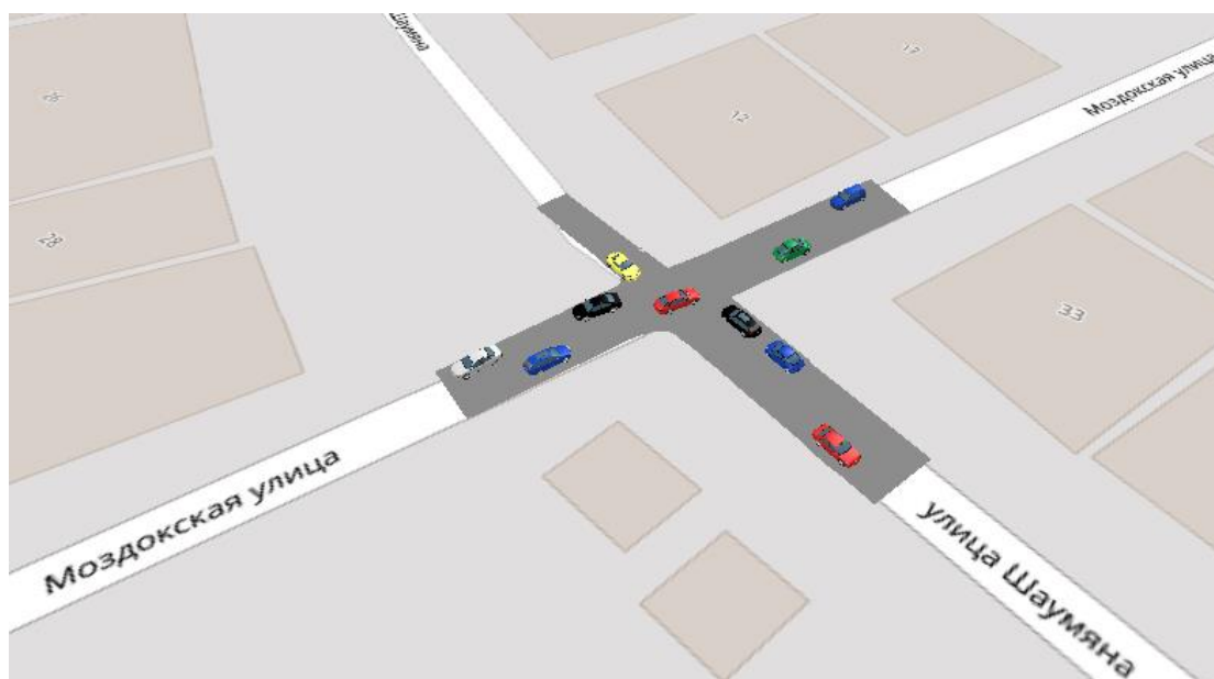
Рисунок 3 – Симуляция транспортных потоков в PTV Vision VISSIM на пересечении ул.Моздокская и ул.Шаумяна
