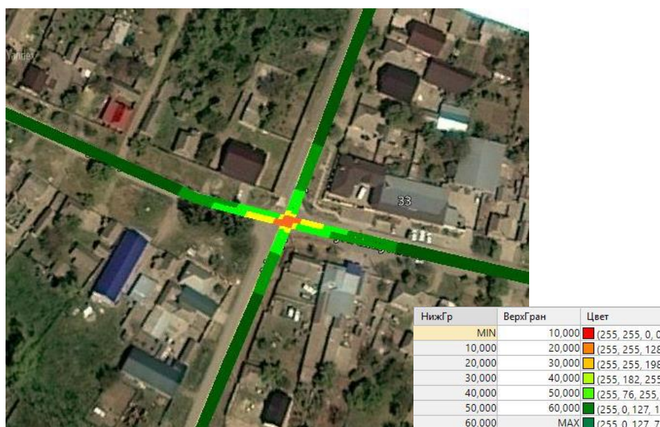
Рисунок 5 – Карта загрузки УДС в районе пересечения ул.Моздокская и ул.Шаумяна для существующего положения
